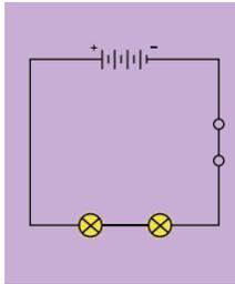
Un interruptor apagado abre el circuito y detiene la corriente eléctrica.
