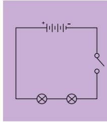
Cuando un interruptor está encendido, cierra el circuito y permite que las cargas fluyan a través de los dispositivos eléctricos.
